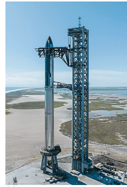
SpaceXのStarshipは二段式で高さ120m。宇宙空間に100t以上の衛星や物資を運ぶことができる。衛星を軌道に投入した後は自力で地球上に戻ってくる完全に再利用可能な大型ロケットだ。
