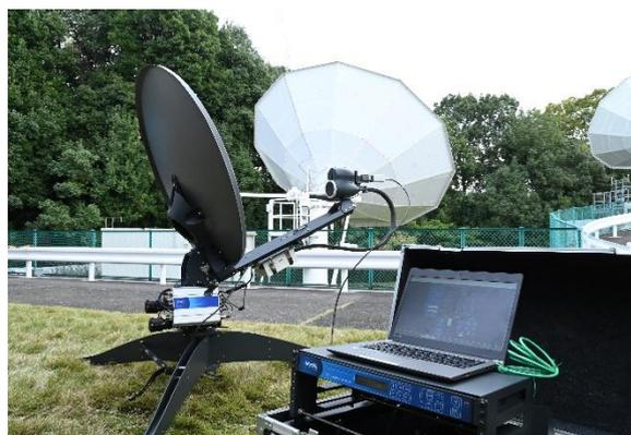
(右) 試験で使用する可搬型地球局 (VSAT)
