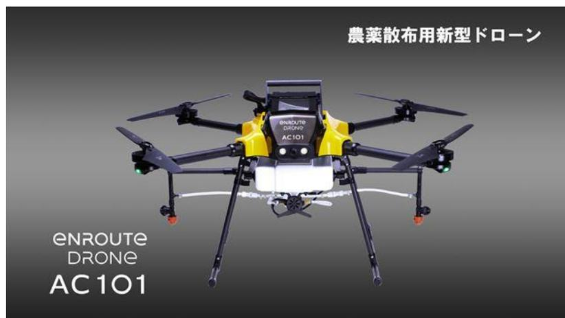
新型ドローン AC101 は、取り外しを不要にした折りたたみ式プロペラを4基搭載。バッテリー交換効率を向上し、タンクにはスムーズな脱着を実現したレール式構造を取り入れ、作業後のメンテナンスも容易にするなど、機体本体とオプションパーツにおいて大幅な改良を加えました。その結果、10Lの薬剤タンクを搭載する従来の大型機 AC1500 の機体重量（バッテリー除く）11.9kg に比べ、40%もの軽量化と
