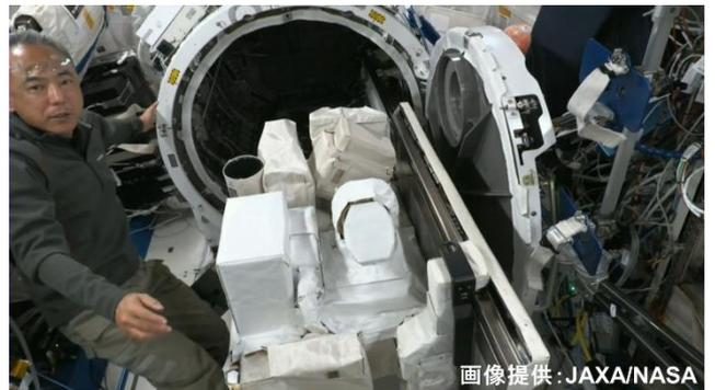
図 4 今回開発した SeCRETS(写真中央)と同装置を船外実験プラットフォームに取り付けた古川宇宙飛行士。この写真を軌道上でワンタイムパッド暗号化して地上に送信後、復号により取得に成功した。
