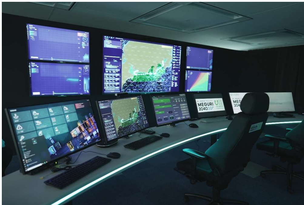
<図1「陸上支援センター」のブリッジ AI の支援などを受けて操船>
