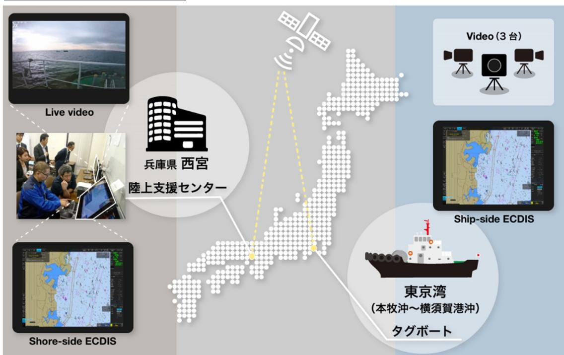
「有人遠隔操船システム」(注2)を搭載し、東京湾上にあるタグボート(以下本船)(注3)を、約400km離れた兵庫県西宮市の陸上支援センターから遠隔で操船し、東京湾内の本牧沖と横須賀港沖間(約12km)を航行させました。スカパーJ S A Tは本実船試験において、船舶向け衛星通信システムの提供および、衛星回線と携帯回線(LTE/3G)の切替えなどの通信ネットワーク構築に協力しました。
