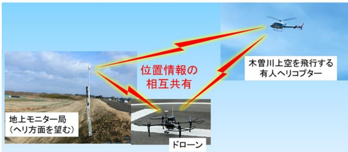
図6 実験の様子(ドローン、有人ヘリ、地上モニター局相互の位置情報共有)
