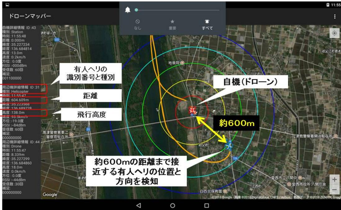
図7 地上局タブレット画面(600m先でドローンに接近する有人ヘリの位置、方向、高度を把握)
